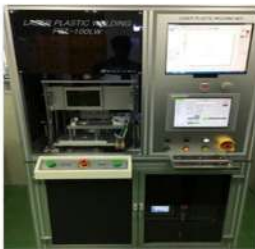
Laser welding 1호
